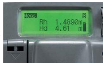
Digitální čtení, pomocí kódové nivelační laťe. Výsledek je zobrazen do 3 vteřin.
